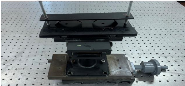
4. แท่นยึดกล้องตรวจการณ์กลางวันแบบสองตา (Binocular Clamp)
