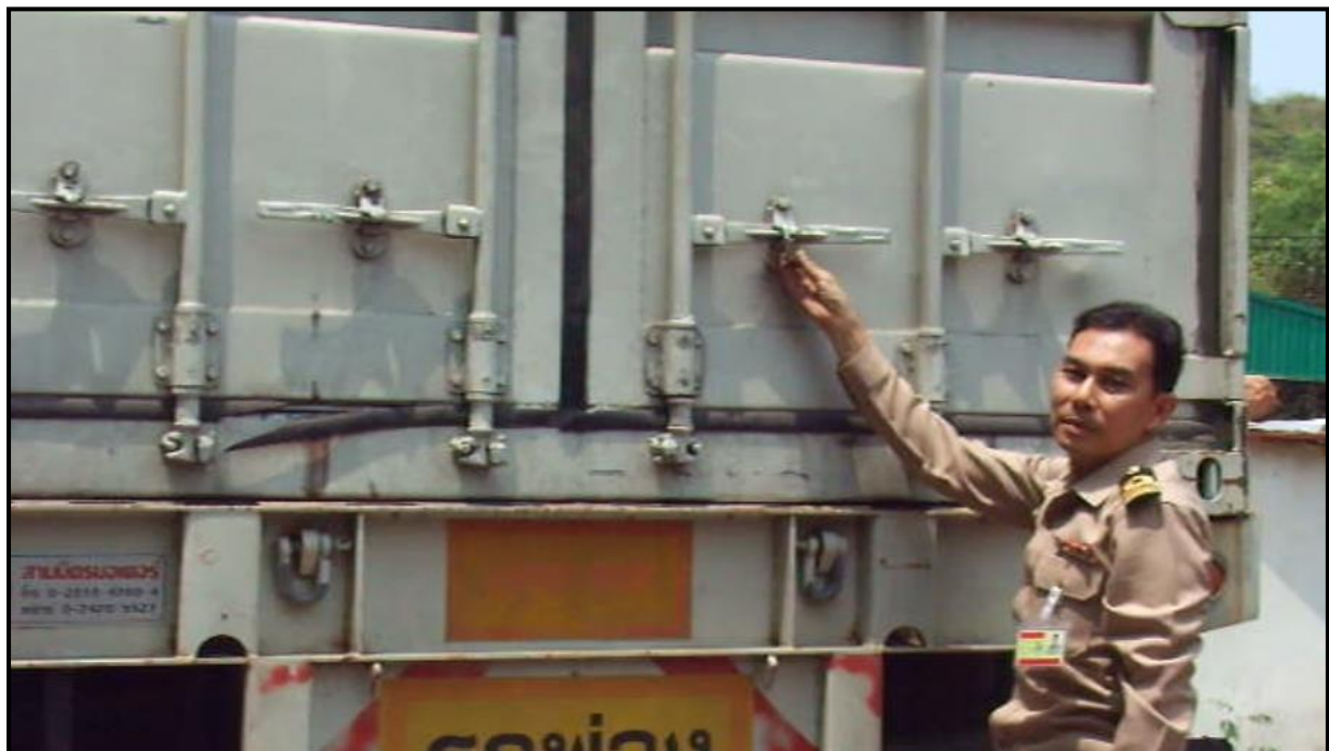
ภาพที่ ๔ : ล็อกประตูตู้คอนเทนเนอร์ด้วยกุญแจเพื่อความปลอดภัยในการลำเลียง
