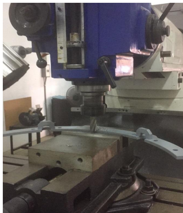
ปาดแผ่นรับจำกัดมุมหันให้เครื่องมืออัตโนมัติเข้าได้
