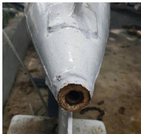
ถอดสลักเกลียวที่ด้านท้ายลูกลอย ขนาด ๕ โดยใช้ประแจ ขนาด ๑ นิ้ว
