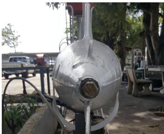
ถอดสลักเกลียวที่ด้านท้ายลูกลอย ขนาด ๕ โดยใช้ประแจ ขนาด ๑ นิ้ว
