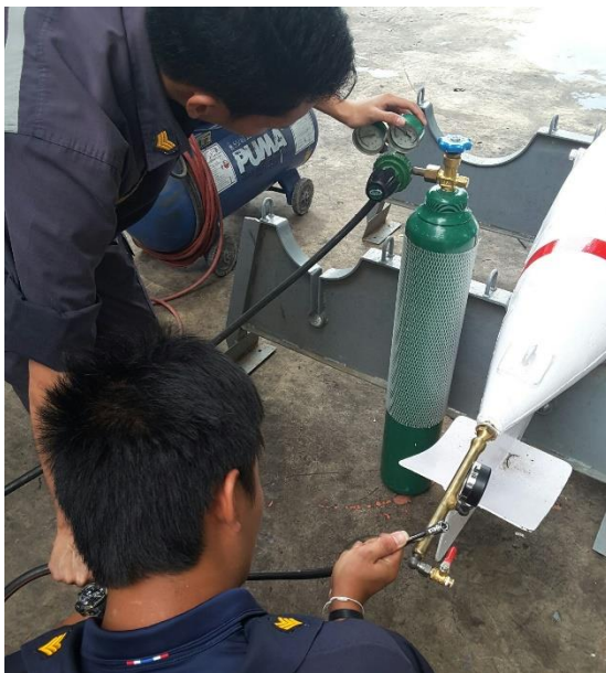
นำขวดอากาศที่ประกอบหัวสำหรับเติมลม เรียบร้อยแล้ว มาเติมเข้าที่หัวเติมลม ของ อุปกรณ์ตรวจรั่ว
