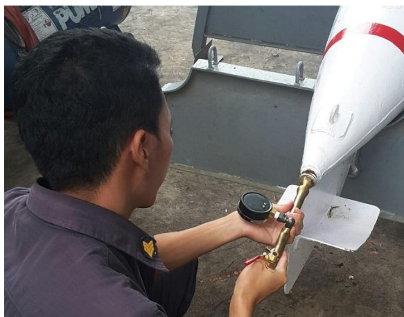
สวมแหวนกันรั่วเข้าที่ด้านปลายสลักเกลียว อุปกรณ์ตรวจรั่ว ๆ แล้วนำสวมเข้ากับลูกลอย
