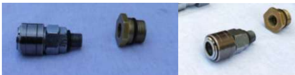
เกลียวต่อที่สร้างขึ้นใหม่พร้อมชุดเติมแบบปลดเร็ว (Quick Coupler)
