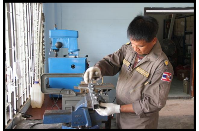
ขึ้นรูปล้อตัวส่งเครื่องบินเป้า
