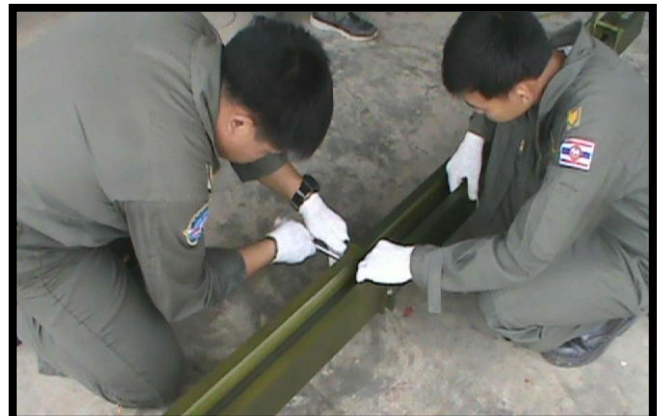
ประกอบรางส่งเครื่องบินเข้าด้วยกัน
