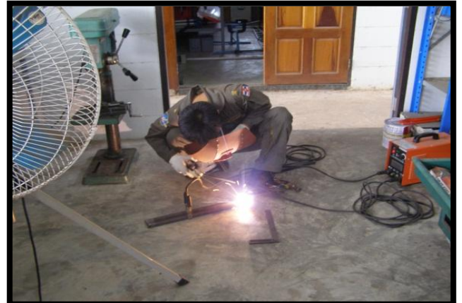
ขึ้นรูปตัวส่งเครื่องบินเป้า
