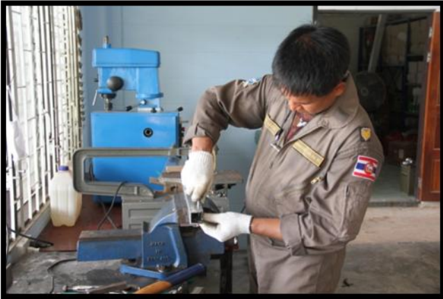
ขึ้นรูปล้อตัวส่งเครื่องบินเป้า
