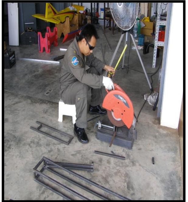
การขึ้นรูปขาจับรางส่งเครื่องบินเป้า
