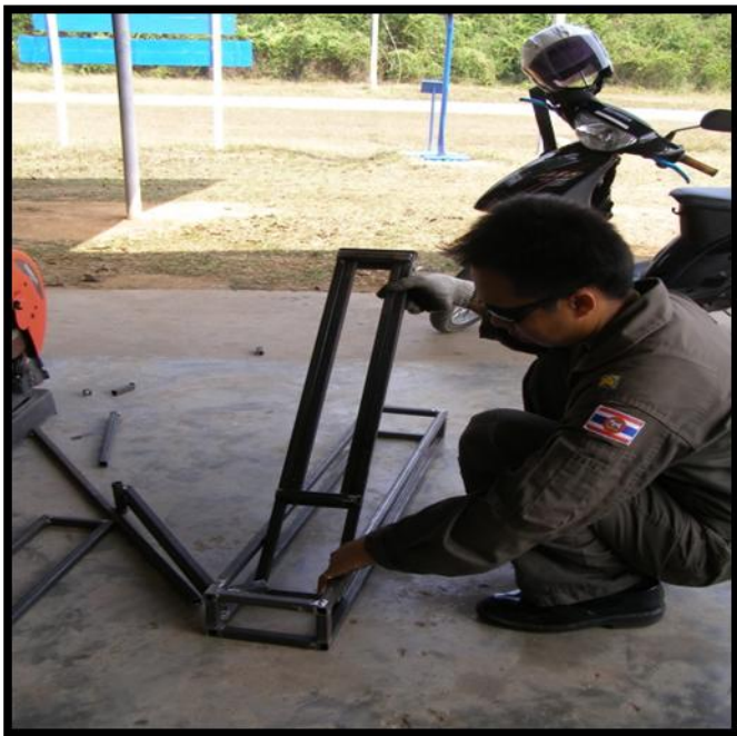
การขึ้นรูปขาจับรางส่งเครื่องบินเป้า
