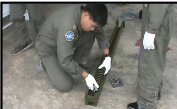
ประกอบสปริงรับแรงกระแทกเข้ากับราง
