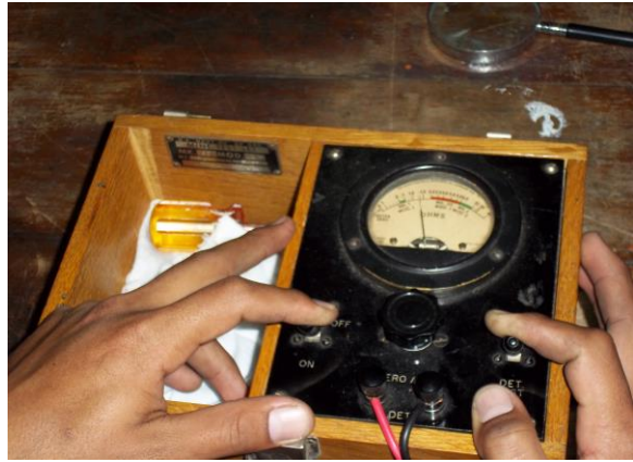
การทดลองชนวนด้วยเครื่อง TEST CHAMBER MK.1 MOD 1 และ TEST SET MK.32 MOD 1
