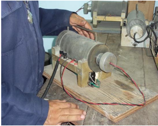
การทดลองชนวนด้วยเครื่อง TEST CHAMBER MK.1 MOD 1 และ TEST SET MK.32 MOD 1
